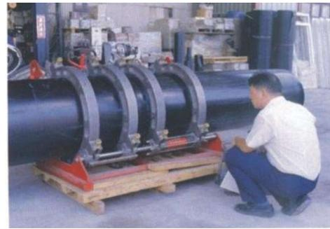
電熱板を取り外し、溶融した両端をすばやく接合し、段階的に圧力を加えて溶接ビーズが形成されるまで続けます。その後、接合部が指で触れる程度まで冷却されるまで圧力を保持します
