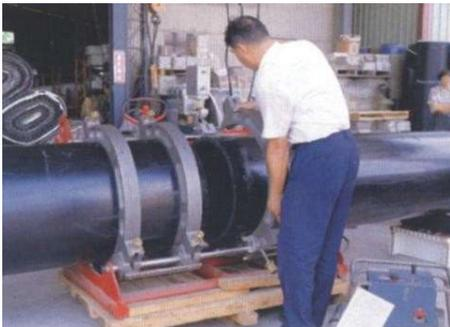
接合する2本の管を溶接機に固定します
