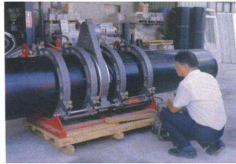
ブレードを2本の管の間に置き、接合面を整えます
