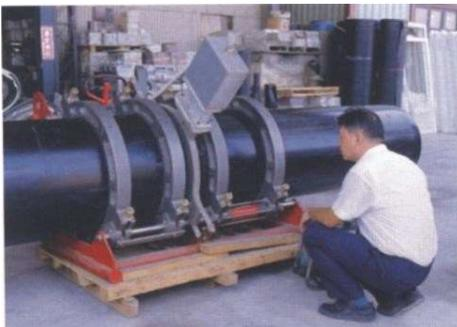
電熱板を挿入し、2つの接合面を加熱・加圧し、完全な溶接ビーズが現れるまで続けます
